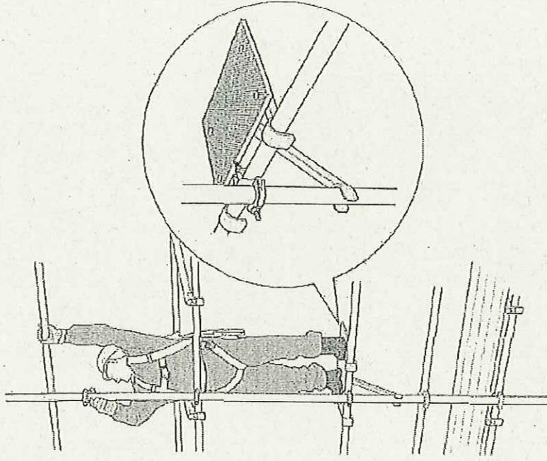
例3：作業台を用いた先行的な手すりの設置
